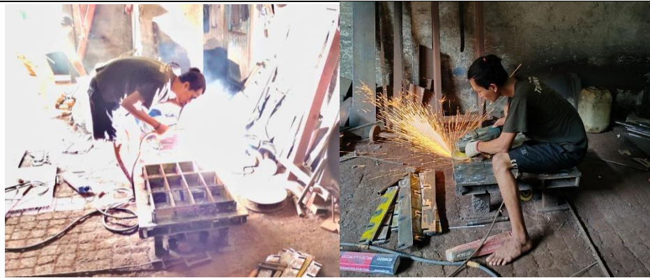
Gambar 1. Pekerja Tidak Memakai APD Saat Menggerinda dan Mengelas
