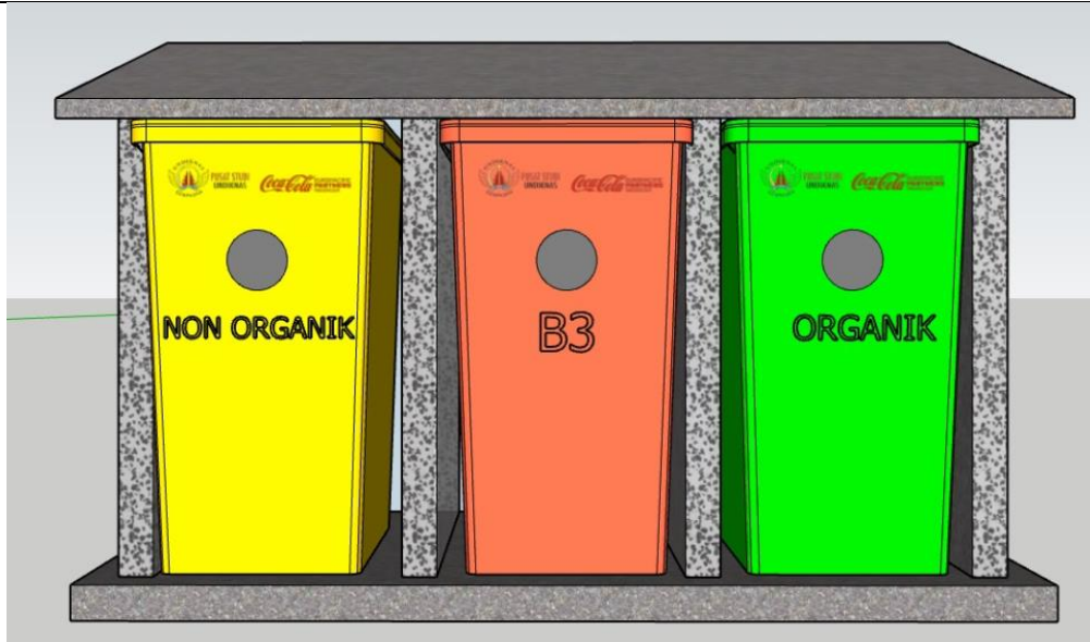
Gambar 5. Tampak Bak sampah beton Berisi Jenis-Jenis Bak Sampahnya
