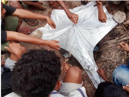
Gambar 2. Pembuatan Media Penangkapan Uap Air Panas melalui Plastik Bening yang Dirancang Berbentuk Payung Berdiri
