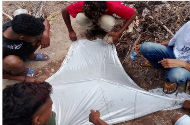
Gambar 2. Pembuatan Media Penangkapan Uap Air Panas melalui Plastik Bening yang Dirancang Berbentuk Payung Berdiri
