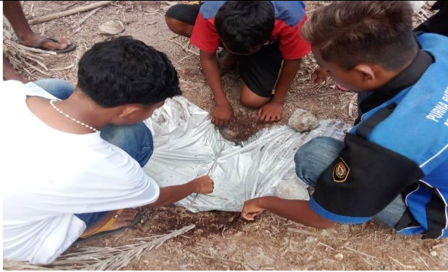
Gambar 3. Pembuatan media penangkapan uap air panas melalui plastik bening yang dirancang berbentuk payung terbalik
