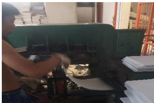
Gambar 7. Proses Pengepresan menggunakan Oven dan Mesin Press
