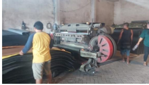
Gambar 5. Proses pembelahan bahan menggunakan Mesin Siset
