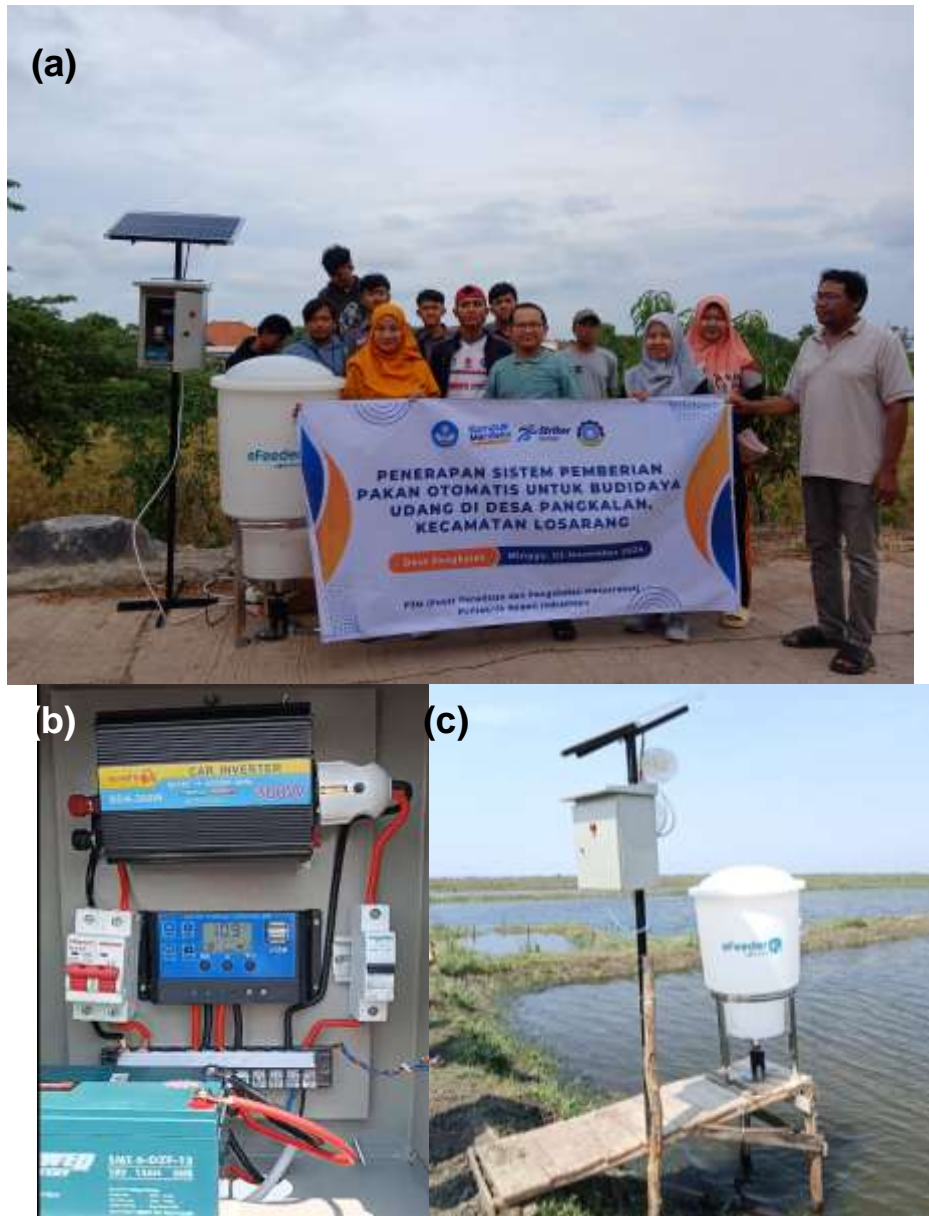
Gambar 5 Implementasi Alat Pakan Otomatis Berbasis Tenaga Surya di Desa Pangkalan, Kabupaten Indramayu. (a) Serah Terima Alat kepada Ibu Kusnerih, Ketua BUMDes Sejahtera Abadi Pangkalan, (b) Kontrol Panel Tenaga Surya, (c) Pemasangan Alat Pakan Otomatis Berbasis Tenaga Surya di Lokasi Tambak
