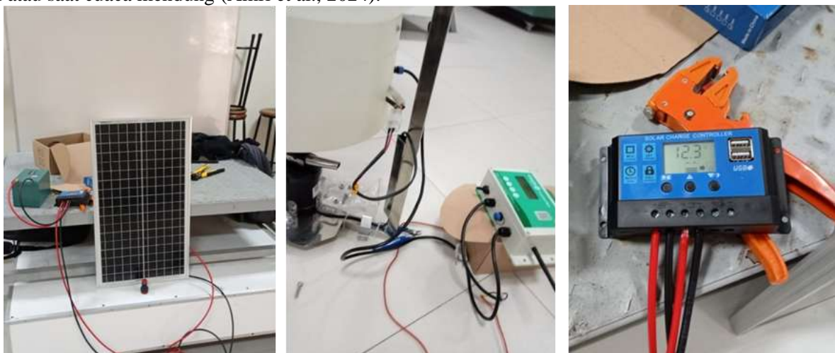
Gambar 4. Proses Pengintegrasian Alat Pakan Otomatis dengan Teknologi Solar Surya
