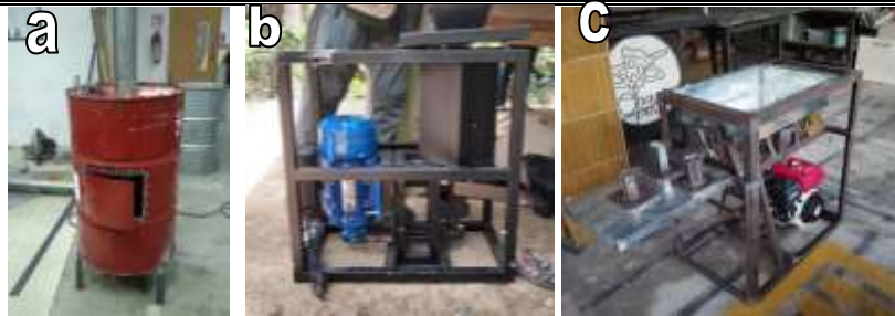
Gambar 3. Alat-alat untuk memproduksi biobriket arang. a. drum pengarangan (Langi et al., 2017); b. alat penghancur arang; c. alat pencetak biobriket arang
