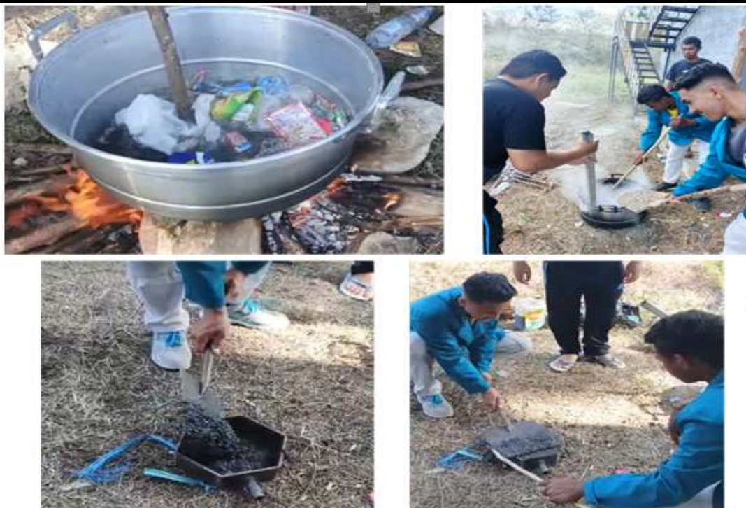
Gambar 5. Foto proses pembuatan paving block dari sampah plastik.
