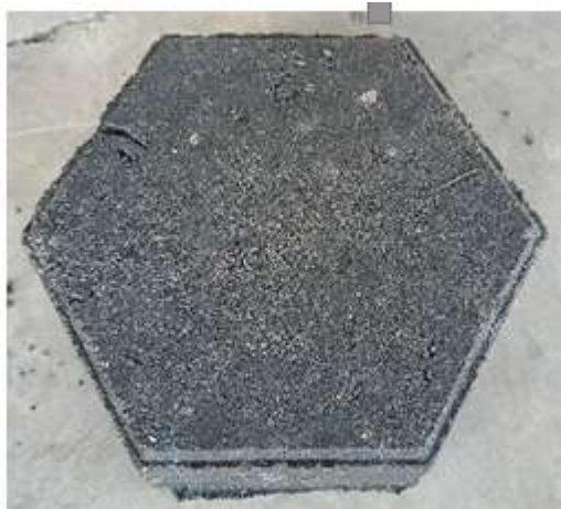
Gambar 6. Foto paving block yang dibuat dari campuran sampah plastik dan pasir.
