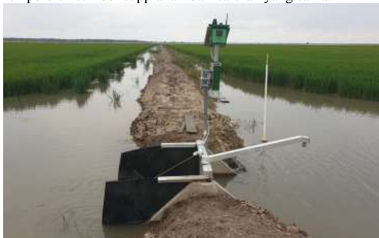
Gambar 7. Automatic water gate actuator (Sumber: Tim Penulis, 2025)
