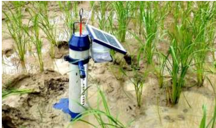
Gambar 6. Sensor ketinggian air (Sumber: Tim Penulis, 2025)
