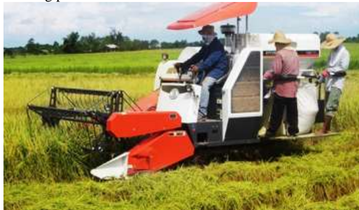
Gambar 10. Mesin pemanen padi combine harvester (Sumber: Tim Penulis, 2025)
