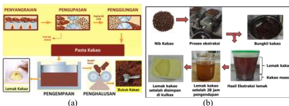
Gambar 2. Ilustrasi proses produksi lemak kakao (a) sistem pengempaan (Sumber : Sri, 2022); (b) ekstraksi menggunakan mesin press (Sumber : Dokumentasi Pribadi dan Mitra)
