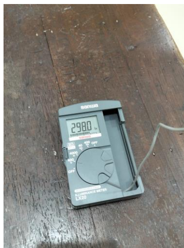
Gambar 5. Hasil pengukuran lux setelah penggantian lampu 3300 lumen.
