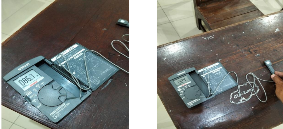
Gambar 3. Hasil pengukuran intensitas cahaya ruang kelas LPQ An-Nur (a) tanpa pencahayaan lampu (b) dengan pencahayaan lampu.
