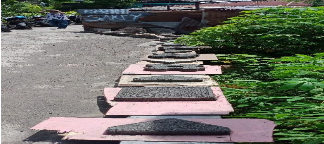
Gambar 7. Hasil cetakan paving blok
