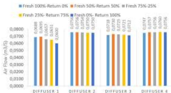
Gambar 8. Grafik Distribusi Air Flow pada Kondisi Fan speed high (459 CFM)
