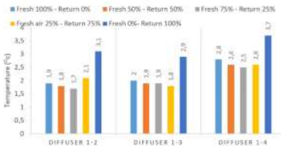
Gambar 6. Grafik Heat Gain pada Kondisi Fan Speed High (459 CFM)
