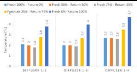
Gambar 7. Grafik Heat Gain pada Kondisi Fan Speed Low (388 CFM)
