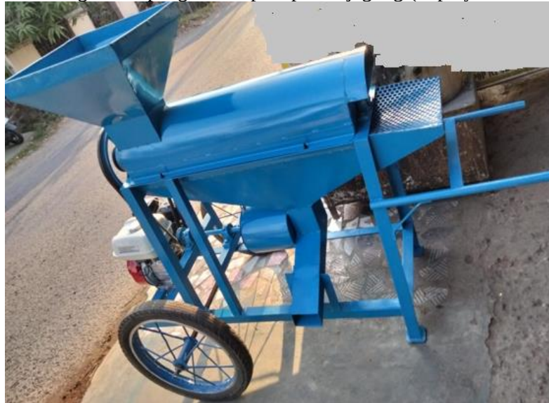
Gambar 3. Hasil Perakitan Alat Pemipil Jagung Mekanis
