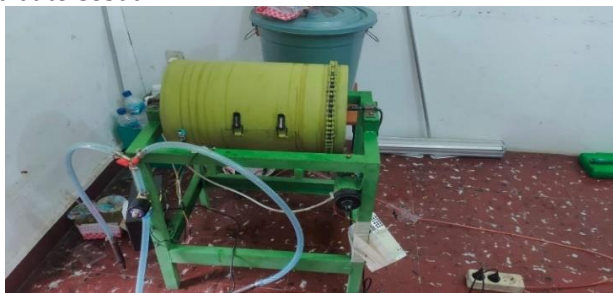
Gambar 9. Hasil Akhir Mesin Pengering Biji Kopi
