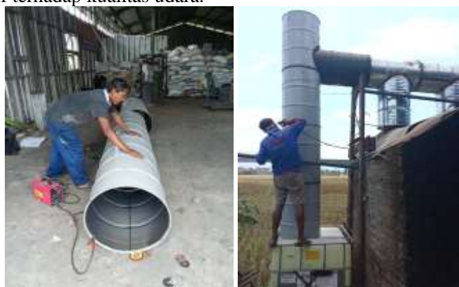
Gambar 6. Proses Pembuatan Cerobong pada Tungku Pembakaran Sampah
