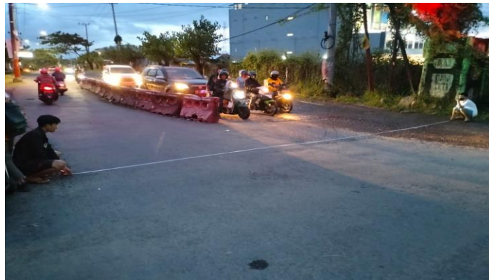
Gambar 4. Pengukuran Geometrik Simpang Bersinyal sumber: dokumentasi pribadi, 2023
