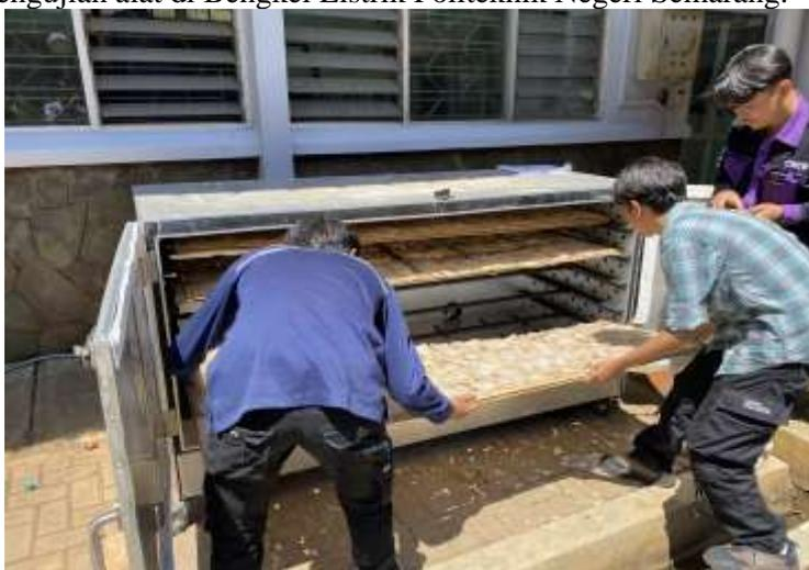
Gambar 4. Proses pengujian pengeringan adonan kerupuk
