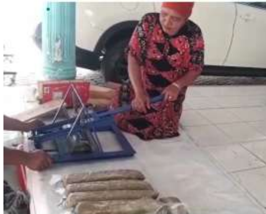
Gambar 6. Proses Penggunaan Mesin Pemotong Adonan Kerupuk
