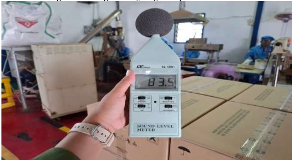
Gambar 3. Pengukuran Kebisingan di Lingkungan Kerja PT Tritama Wirakarsa
