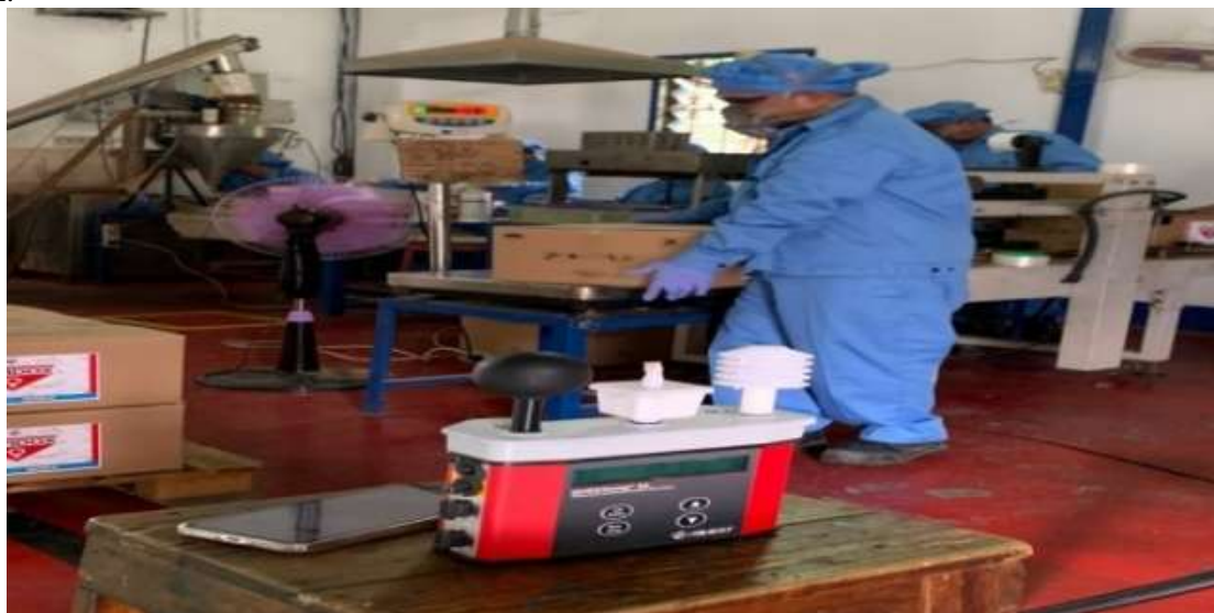
Gambar 2. Pengukuran Iklim Kerja
