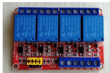
Gambar 8. ESP32 WiFi dan Relay 4 Channel serta pemasangan sirkuit IoT dalam Barrier box
