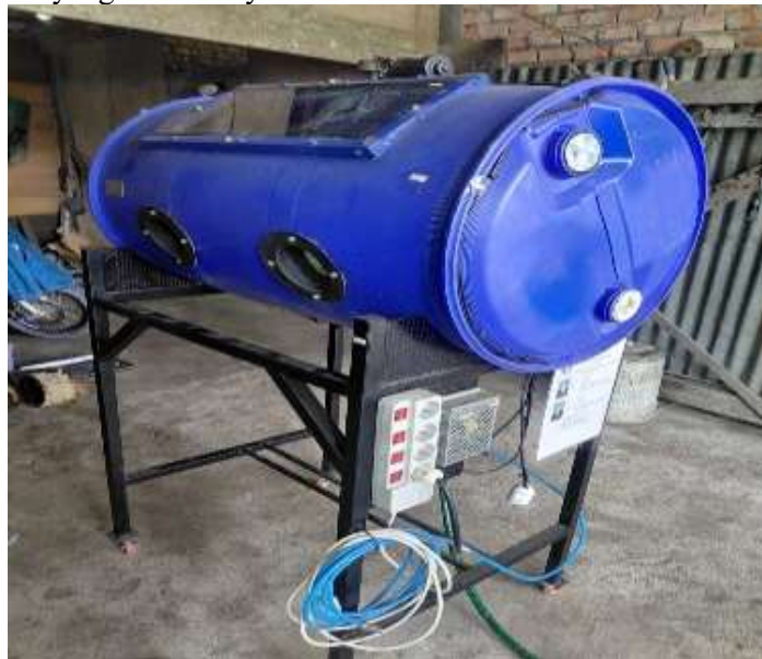
Gambar 2. Mesin Vapor blasting
