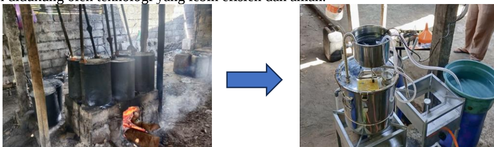
Gambar 4. Perbandingan penyulingan metode konvensional dengan mesin distiler
