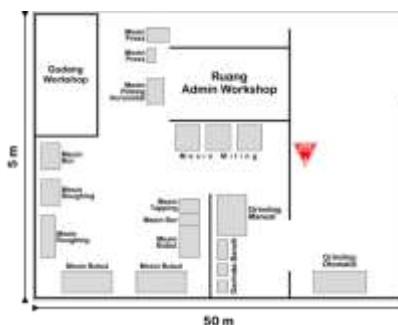
Gambar 2. Lokasi Penempatan APAR di Area Workshop (Sumber: Data Primer, 2024)
