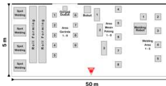
Gambar 5. Lokasi Penempatan APAR di Area Welding dan Spot Welding (Sumber: Data Primer, 2024)
