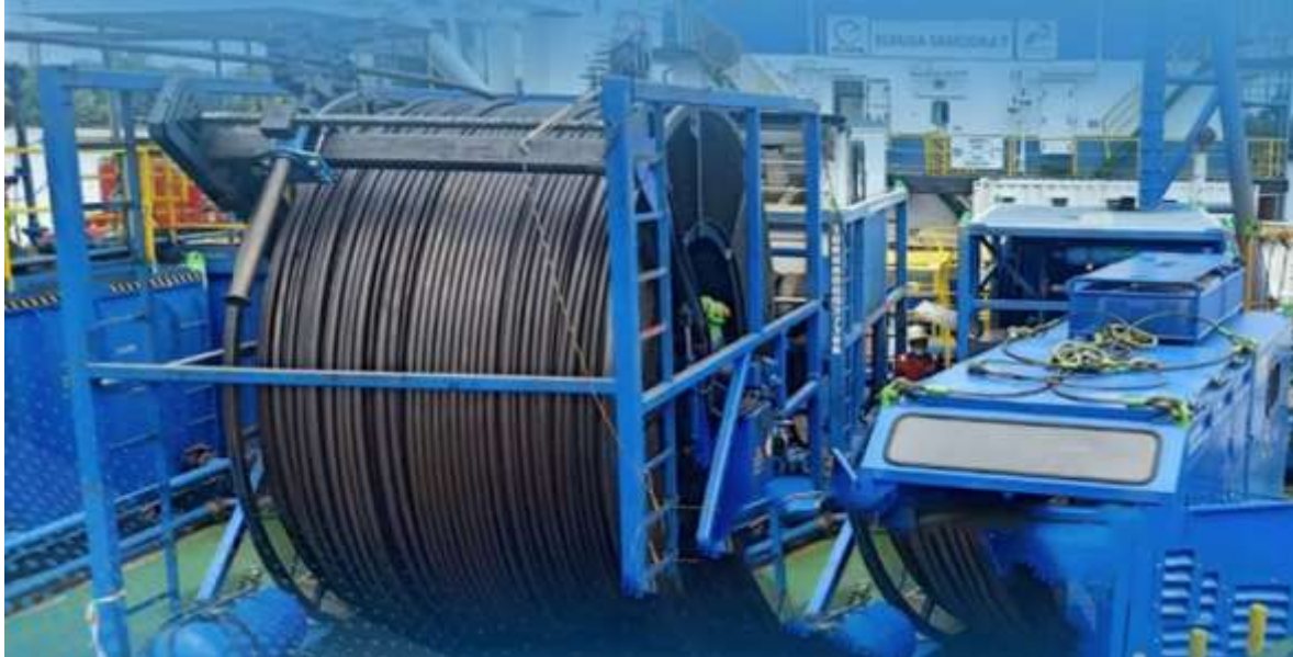
Gambar 1. Unit Coiled Tubing PT Elnusa yang di aplikasikan untuk intervensi sumur di lapangan migas darat/pantai.
